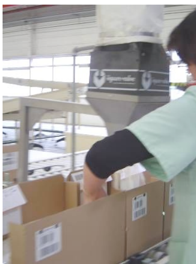
Figura 7 – Posto de preenchimento das caixas com calage
